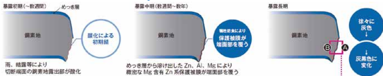
屋外暴露試験後の切断端面部断面状態(暴露18ヶ月後)
