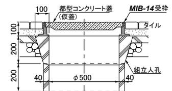
3. 450,500サイズは車両の通過等により蓋が回転しないよう回転防止構造を採用しております。
