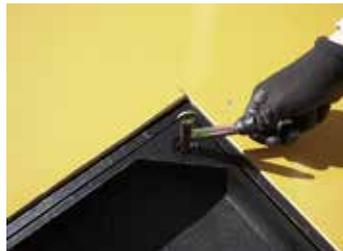
2 開閉鍵【MF-44】の六角部分を使用し取手ボックス内の六角穴付ボルトを4ヶ所全て緩めます。
