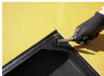
2 開閉鍵【MF-44】の六角部分をを使用し取手ボックス内の六角穴付ボルトを4ヶ所全て緩めます。
