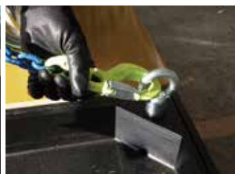
7 スリングフックを専用アイボルトに掛けます。スリングフックがアイボルトに掛かりにくい場合は、クサリの長さを再度調整してください。
