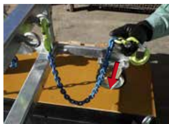
6 吊り金具のクサリ長さを調整してください。クサリコマ数は赤矢印方向に数えて24コマになります。
