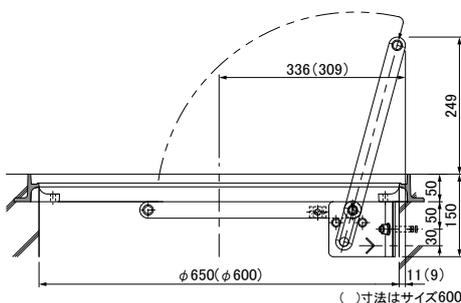
DMHA (DMHB) シリーズ 受枠施工例
