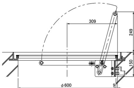
●先付施工例図 **MHT-S60R(B)**
