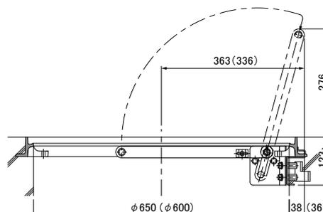
●後付施工例図 **MHT-SA60R(A,B,C)**
