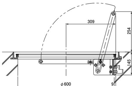
●先付施工例図 **MHT-S60R(C)**
