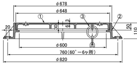
**MGT-2DL** ●質量 蓋:29.8kg 蓋・枠:76.4kg
