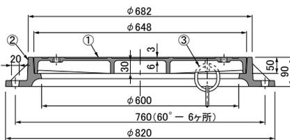
**MGT-6DL** ●質量 蓋:29.8kg 蓋・枠:53.2kg
