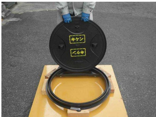
蓋を上げ受枠の横棧（スタンド部）に蓋を落としこみます。写真の様に「キケン」表示を開口側に向けて落としこんで下さい。
