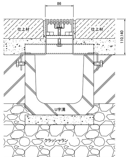
スレンダー側溝蓋は、排水口(グレーチング)を細く目立ちにくくし、排水能力を確保した側溝蓋です。
