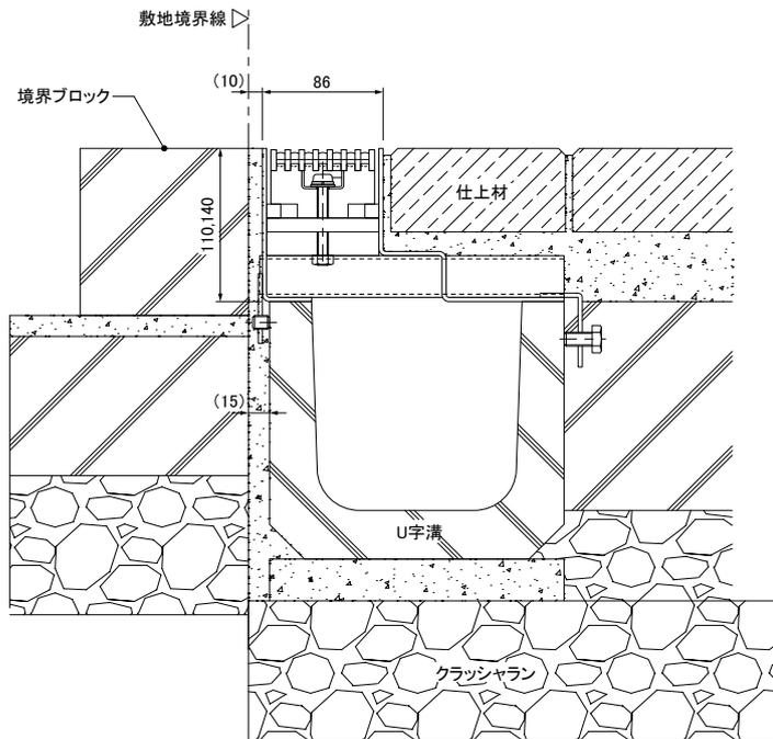
バウンダリー側溝蓋は、排水口(グレーチング)の位置を側溝の片側へ寄せることで、敷地境界(官地=民地など)への設置に適した側溝蓋です。
