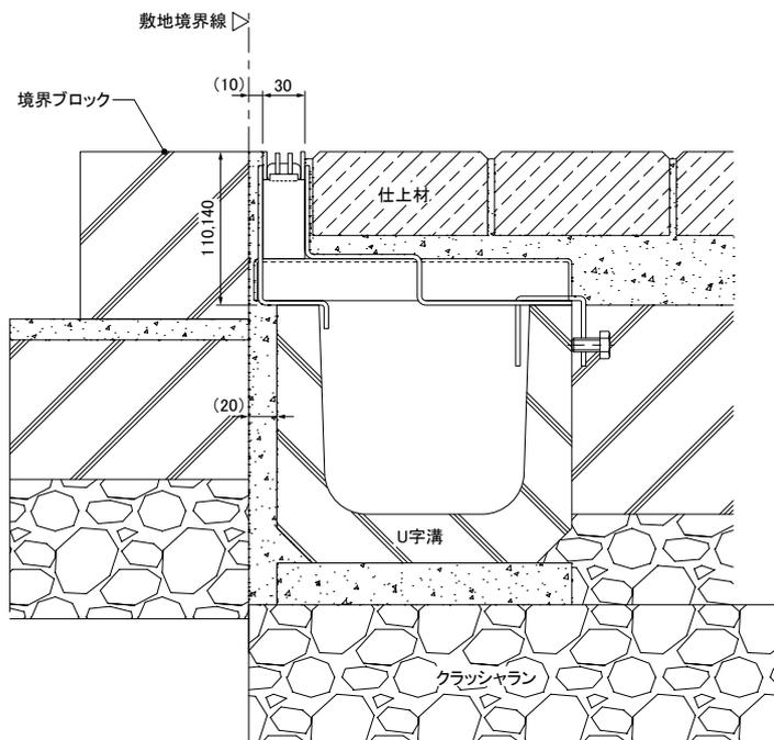
ナロースリット側溝蓋は、排水口(グレーチング)を取外可能タイプで可能な限り細くし、さらにスマートな敷地境界用排水側溝蓋です。
