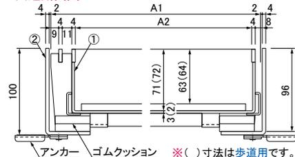
●ボルト固定仕様も規格しております。(目地ピッチ10mm・スキマ6mm)
