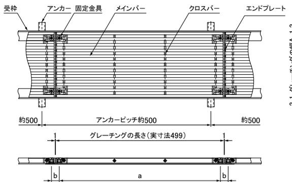
●固定部拡大写真(ピッチ17mm)→
