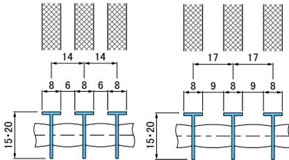
●寸法表 クローズエンド 適用荷重(歩道) ( )はスキマの寸法を表します。
