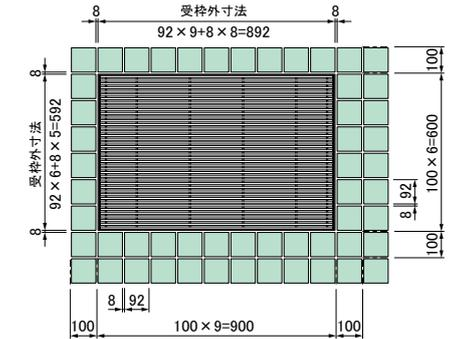
ステンレス製玄関マットは受枠の外寸法が□100mm
