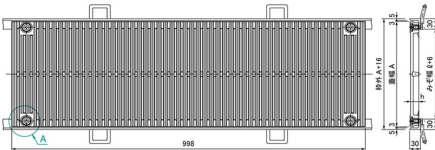
一般用アングル受枠 断面詳細図
