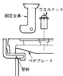
2.固定金具をペデグレートの溝に差し込み枠とセットする。(蓋1枚に4ヶ所)
