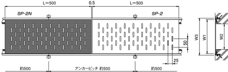
●受枠のコーナー部は図1の様な納まりでお願いします。図2の様な納まりの場合は、蓋裏に補強材が必要になります。(SP-2,2N,2NL共通)
