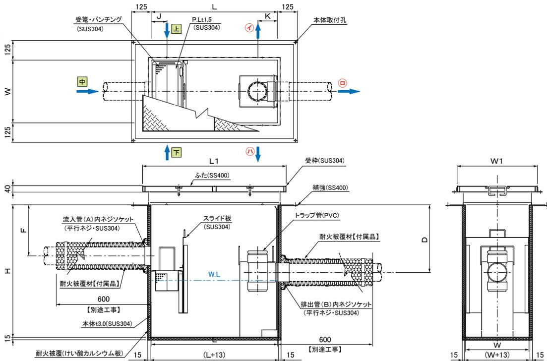
●寸法・仕様表 配管口径が1サイズUPも日本阻集器工業会の認定品扱いは可能です。 下表以外の寸法でもご要望に合わせて製作いたします。
