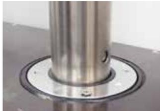
支柱を引上げ、右回転させると約10mm降下し、固定されます。
