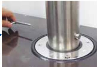
ストッパーピンが出ている状態で専用キーを抜いていただくと、ストッパーピンが固定されます。ストッパーピンの解除は、六角の専用キーにて反対に廻してください。
