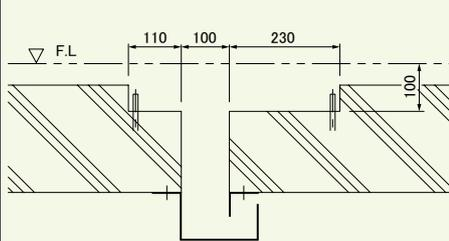
② 枠をセットし、レベル位置を決定後差し筋にアンカーを溶接固定しモルタルで周囲を補強してください。
