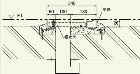
③ 枠周囲の施工が終了しましたら幅止めを外し、枠内面を清掃後、蓋をセットしてください。
