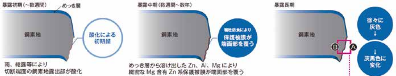
屋外暴露試験後の切断端面部断面状態(暴露18ヶ月後)
