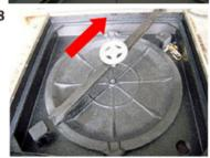
締付バーを矢印方向に ずらしながら取り外し してください。
