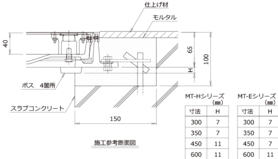
受枠取り付け時には、受枠開口に対して、正方形に躯体を仕上げてください。
