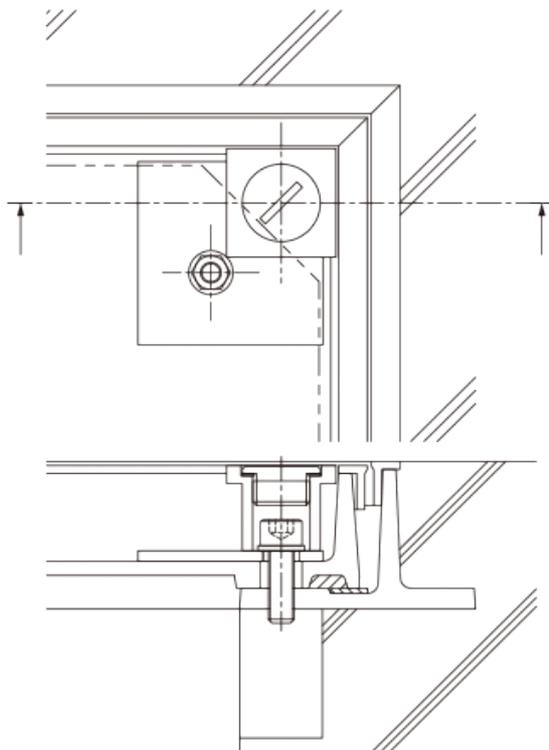
マンホール受枠の固定座（ネジ部）を養生テープ等で下側上側を養生してください。
