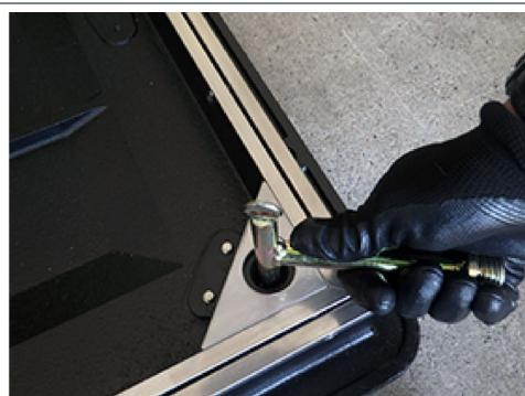
開閉鍵MF-44の六角部分を使用して、取手ボックス内の六角穴付ボルトを緩めます。
