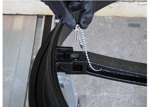
締付バーを赤矢印方向にずらして取り外します。
