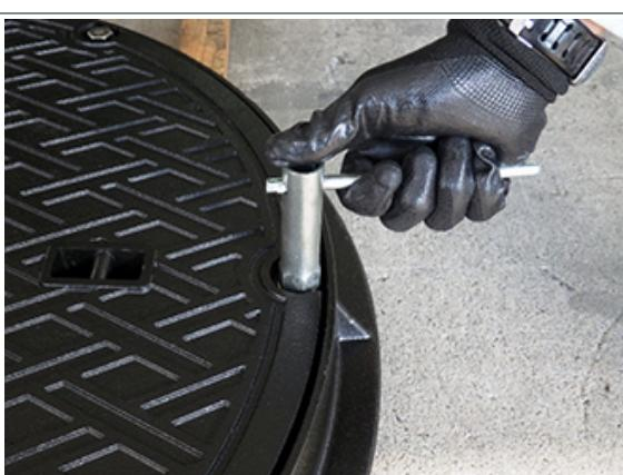
六角ボルトを手締めした後、ボックススパナ：MF-12を使用して締付固定します。
