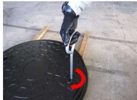
開閉工具【フック：MF-3】を錠ボックスの底部に差し込んだ状態で 90°回転させ ロックを解除します。
