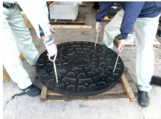
φ900 については 開閉工具【フック：MF-3】と【フック：MF-1】を併用して蓋を持ち上げてください。
