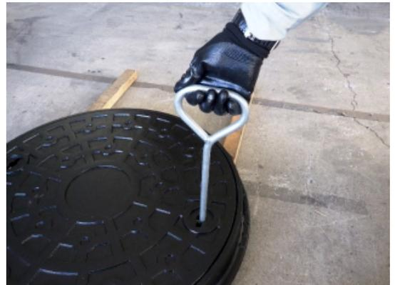
開閉工具【フック：MF-3】を錠ボックスの底部に差し込んだ状態で 90°回転させ ロックを解除します。
