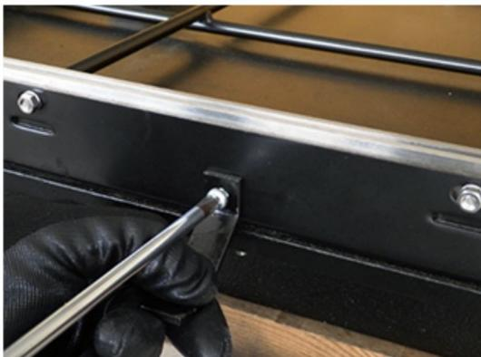
十字穴付きなべ小ねじM5×7でアンカーを固定します。
