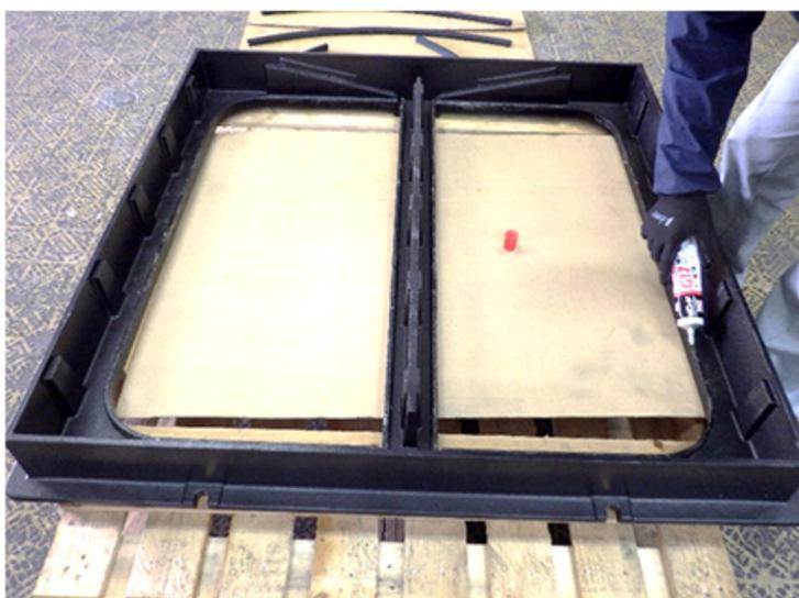
・受枠の立上り部分に接着剤を均一に塗布します。
