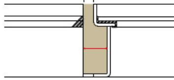
ます枠の下部アングル(側溝枠と突付ける辺)を加工すると、受枠目地間はスキマなく納まりますが、■部のスキマより調整砂(モルタル)が溝内に入り込んできます。
