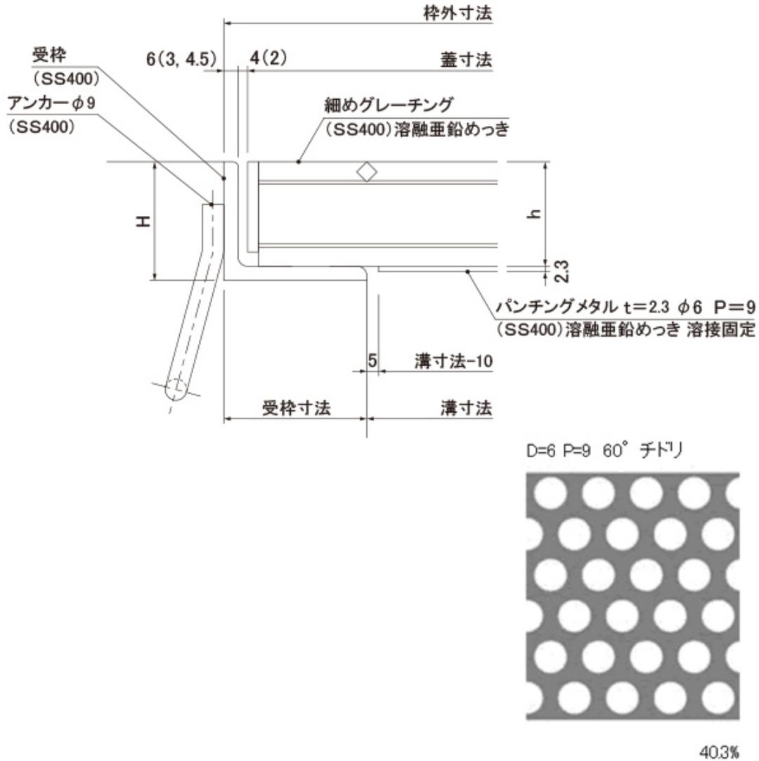
パンチング開口率は40.3%ありますので、雨水は蓋孔より充分に流れ落ちます。
