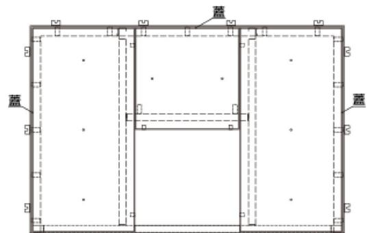
④中棧を受枠に設置して、中棧同士を付属の六角ボルト・ナットで連結して下さい。
